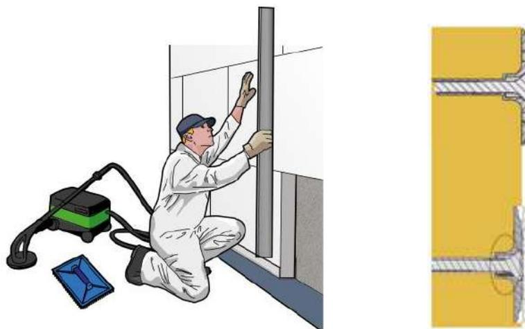
Une fois cette opération réalisée, il faut mettre en place un renforcement au niveau des zones dites sensibles. Pour cela, la pose de mouchoirs aux angles des baies et au niveau des jonctions de rails, vont permettre d'assurer le bon maintien des enduits et empêcher d'éventuelles fissurations.
